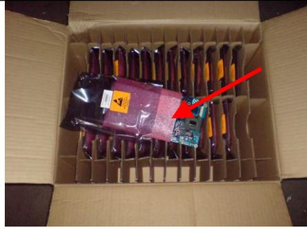
Zusätzlicher Schutz der Bauteile mit Polsterungen
